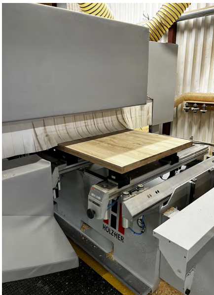
Figur 6. Tre-skiktat dörrblad i ek under profilering hos Meling AS. Foto: Karl-Christian Mahnert.
