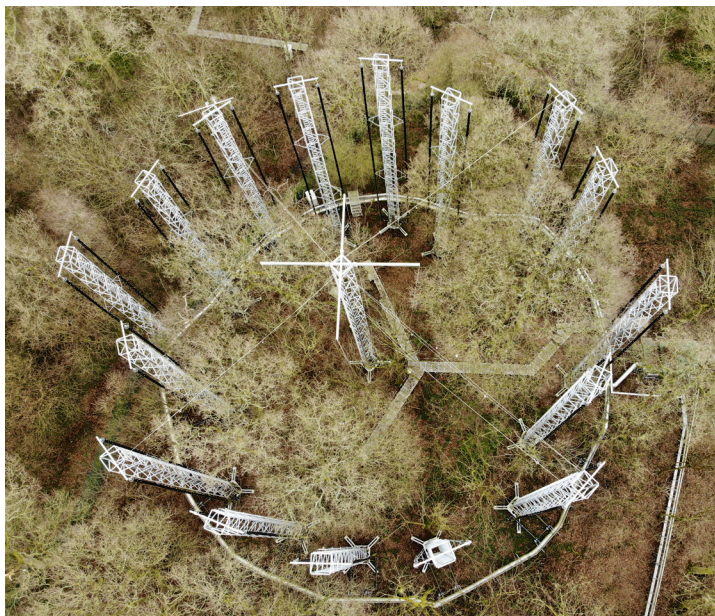
I FACE-försöket utanför Birmingham undersöks hur ökad koldioxidhalt i fri atmosfär påverkar ekskogen. Varje mast är 25 meter hög och ringens diameter 30 meter. Foto: Andrew Priest.
