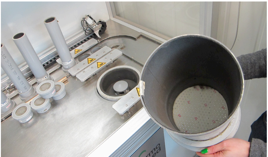
Bilden visar den cylinder i vilken ekollon värmebehandlades genom tillförsel av ånga i ett kontrollerat luftflöde.
