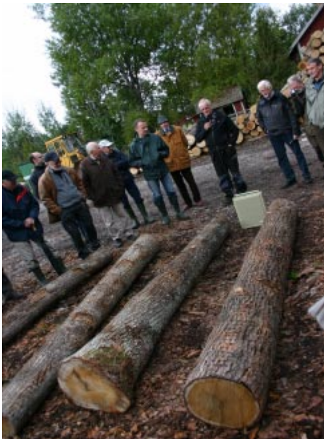
Ekstockar upplagda för ytlig kvalitetsbedömning. De sågas därefter upp i ett ramsåg för kontroll av inre rötskador.
