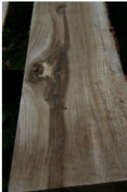
Efter sågning avslöjas att en stock hade en dold kvist med spridd röta.
