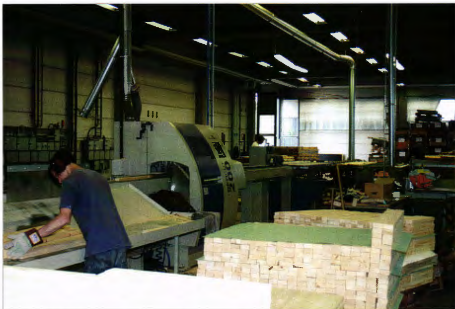
Helautomatisk ämnestillverkning vid Wernerträ. - Foto: Ulf Olsson.
