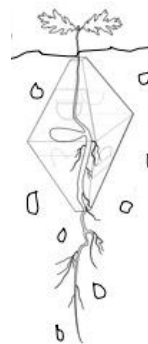
Figur 1. Skyddet är ca 10 cm långt och består av två delar som omsluter ekollon och jord. Rot och skott kan växa ut men ekollonet är skyddat mot predation av smågnagare. Källa: Castro et al. 2015.
